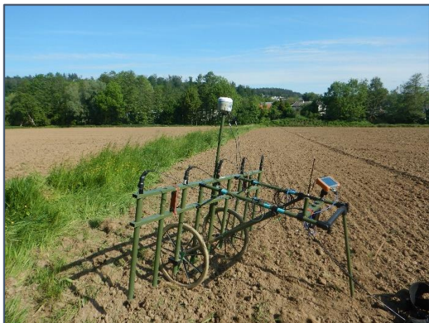
Foto: Mehrkanaliges Fluxgate-Magnetometer mit Sonden der Fa. Sensys auf dem Messgelände
